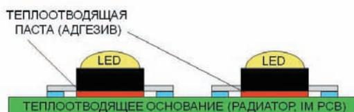
В качестве примера использования теплопроводящих адгезивов может быть рассмотрено приклеивание мощных светодиодов или кластеров на поверхность радиатора или любого другого теплопроводящего основания.
